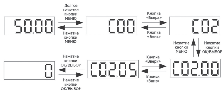
Рисунок 5.2-3. Основные операции с панелью управления
