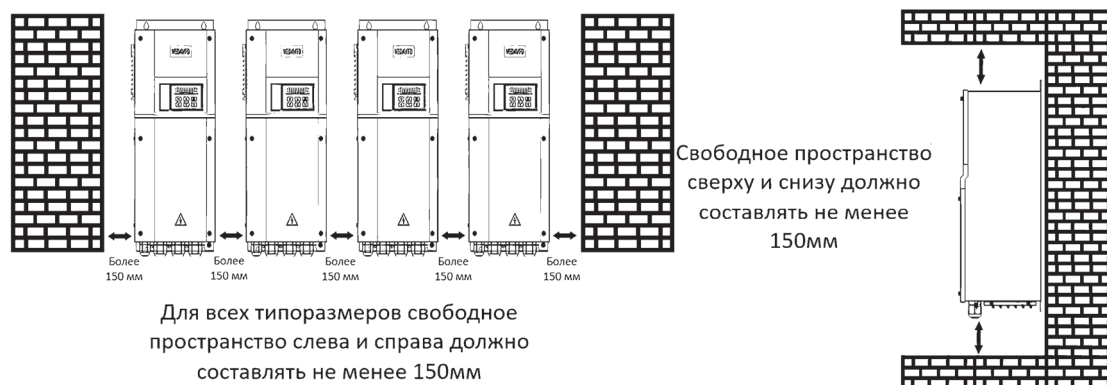
Рисунок 2.7-2. Рекомендуемые монтажные расстояния для преобразователей частоты VF-101 DBC
